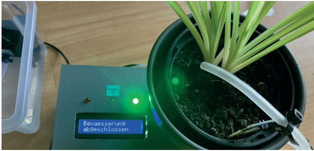
Werner-Heisenberg-Schule, Mikrocontroller-gesteuertes Bewässerungssystem
