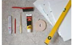
Abbildung 1: Du brauchst einen Gliedermaßstab, einen Stift und einen langen, geraden Gegenstand wie eine Wasserwaage. Einen Handfeger und einen Lappen. Ein Messer. Montagekleber oder doppelseitiges Kleband. Dämmplatten in der richtigen Stärke. Und ein selbstklebendes Schaum- oder Schlauchband für die Abdichtung.
